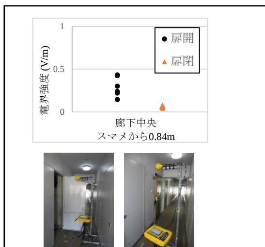
図15 金属製扉の影響調査（地点B）
