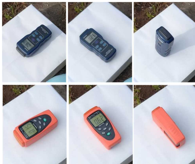
図4 送電線付近における1軸測定器の測定状況（直交する3方向の磁界をそれぞれ測定）
