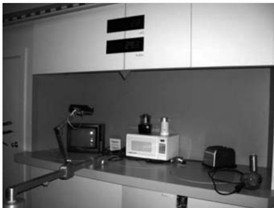
写真① 家電製品からの電磁波を測定する実験装置
