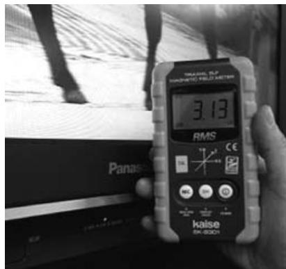
磁界測定器で液晶テレビを測定した時の様子。磁界の強さは3.13 \mu T(マイクロテスラ)を示している
