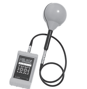
図2 使用した磁界測定器 (Narda S.T.S.社製 ELT-400)
