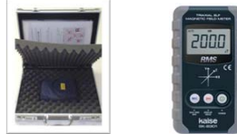
低周波磁界測定器 (kaise SK-8301) ※仕様：40Hz～1kHz
