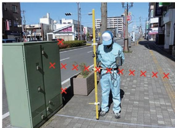
図16 磁界測定風景（路上変圧器：3点測定・距離変化測定）
