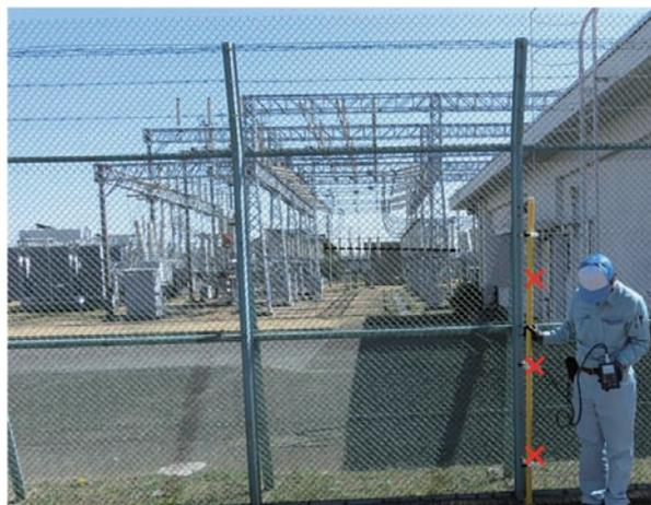
図13 磁界測定風景(変電所:3点測定)
