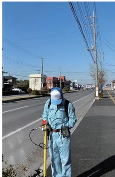
図11 磁界測定風景(架空配電線:1点測定)
