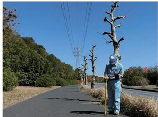
図6 磁界測定風景 (架空送電線：線路方向)
